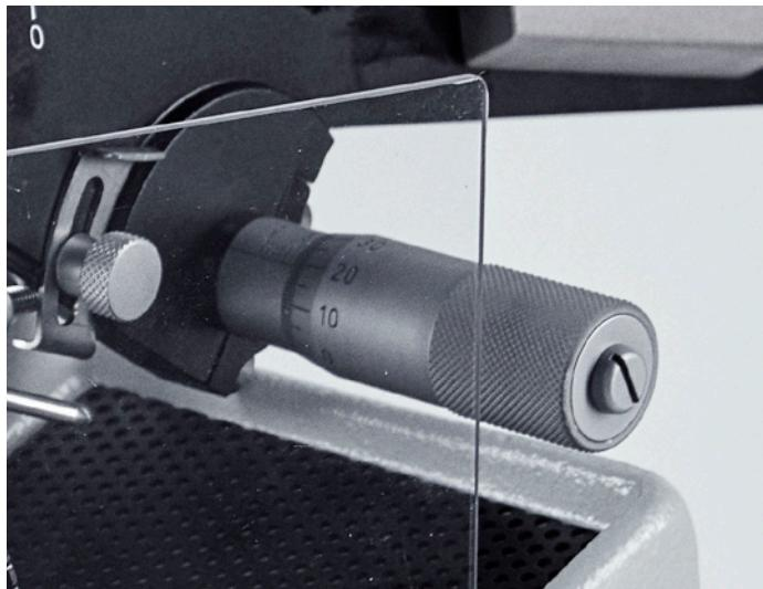
Gracias a su alto grado de precisión, la Minitom le ayudará a ahorrar tiempo y cortar muy cerca del objetivo. Solo se tarda unos minutos en sujetar la pieza y ajustar la prensa de corte y la velocidad de rotación del disco de corte, lo que reducirá aún más el tiempo total del proceso.
