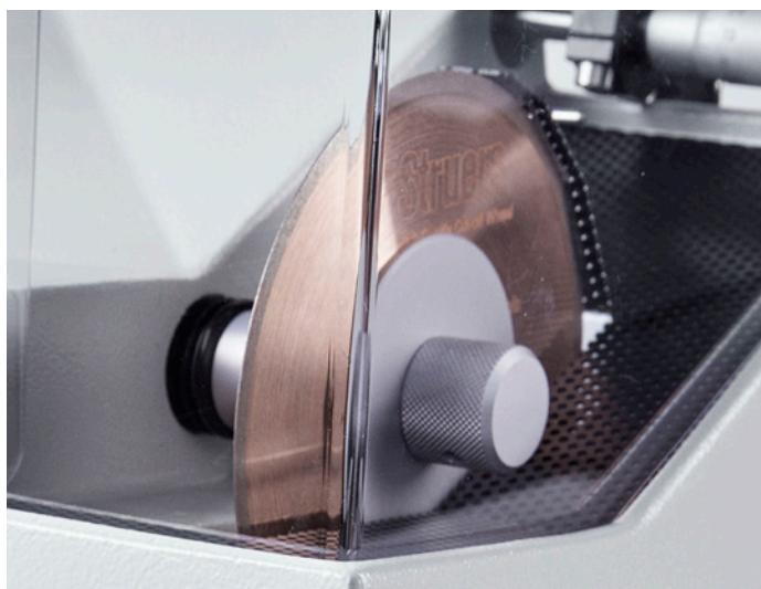
La Minitom le permite cortar piezas con una precisión de  $\pm 0,01$  mm de grosor utilizando el brazo móvil del soporte para muestras y el tornillo micrómetro. Esto hace que sea la solución ideal para piezas pequeñas y delicadas en las que la deformación deba mantenerse al mínimo. La máquina también garantiza unas velocidades del disco de corte constantes, independientemente de cuál sea la carga, para de este modo ayudar a proteger su pieza.
